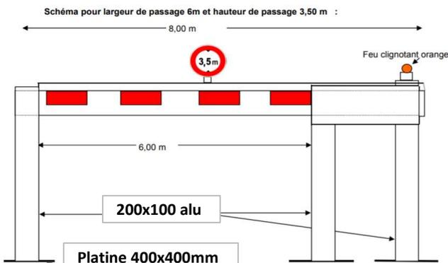
Un feu clignotant orange annonce l'ouverture du portique. Un support panneau et un panneau limiteur de hauteur (à nous préciser) sont nécessaires. Lisse avec bandes réfléchissantes rouges sur 2 faces.
